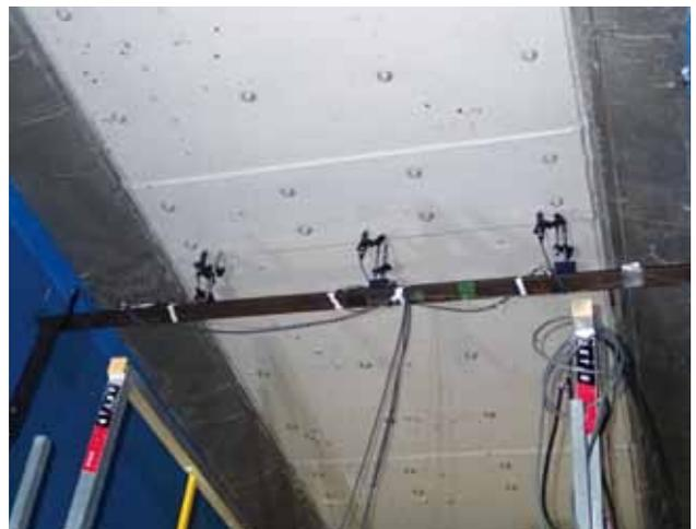
▲鋼板接着部のたわみ計測状況
